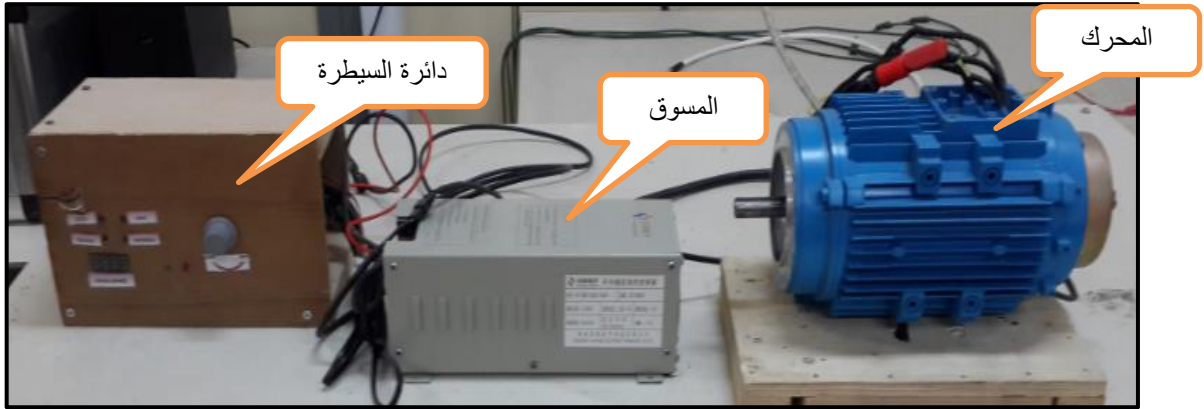
الشكل (١ أ) منظومة المحرك المعاوق المفتاحي
