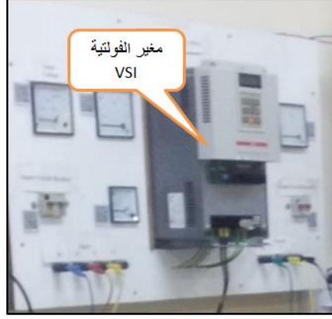
(ب: مغير الفولتية) (ج: نظام تحصيل ومعالجة البيانات ومتحسس التيار)
