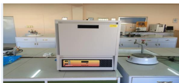
الشكل (١) صورة لجهاز فرن مبرمج
