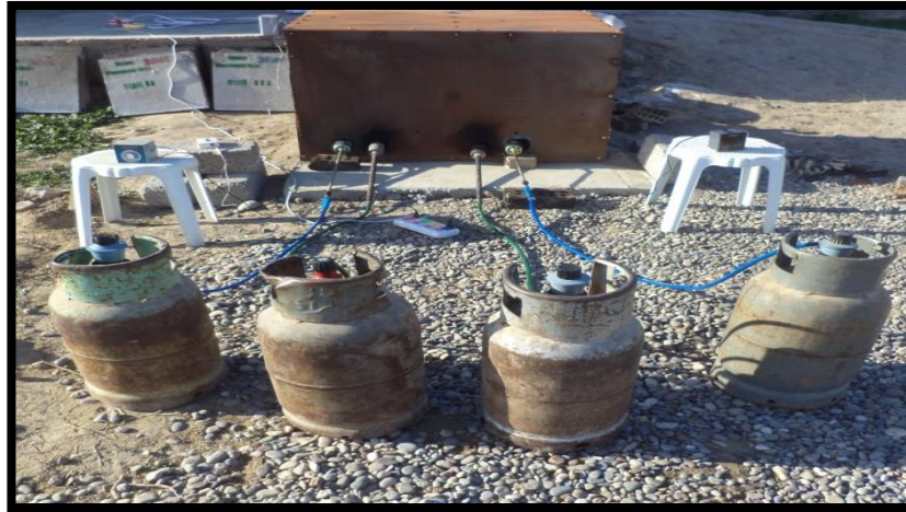
الشكل (1): الفرن الغازي المصنع والمستخدم لحرق النماذج.
